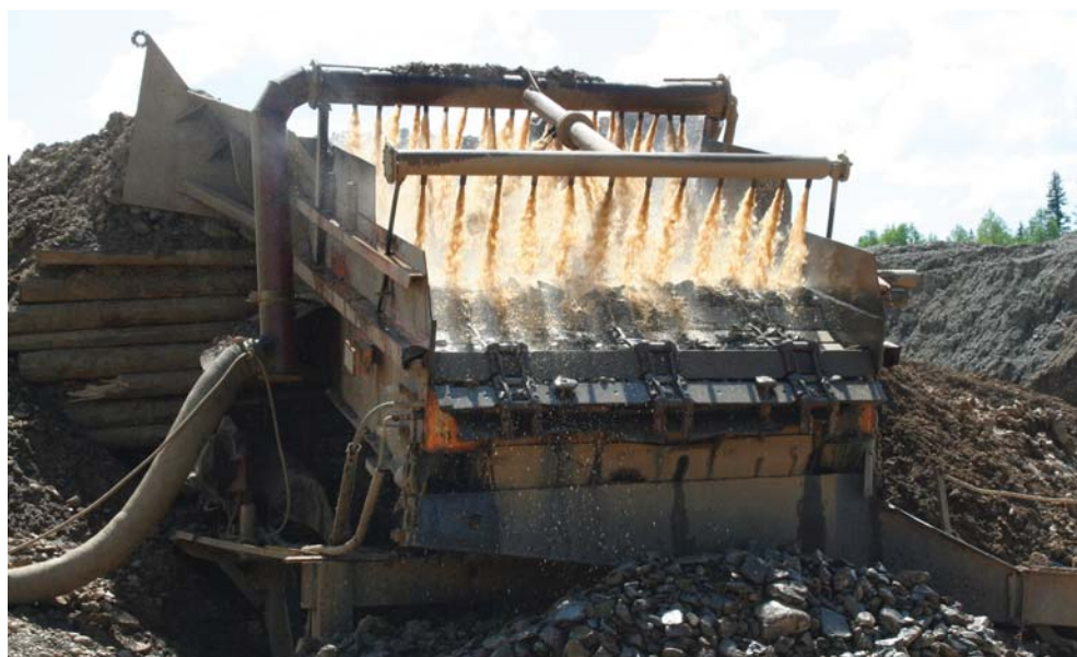
Процесс промывки золотосодержащей породы
